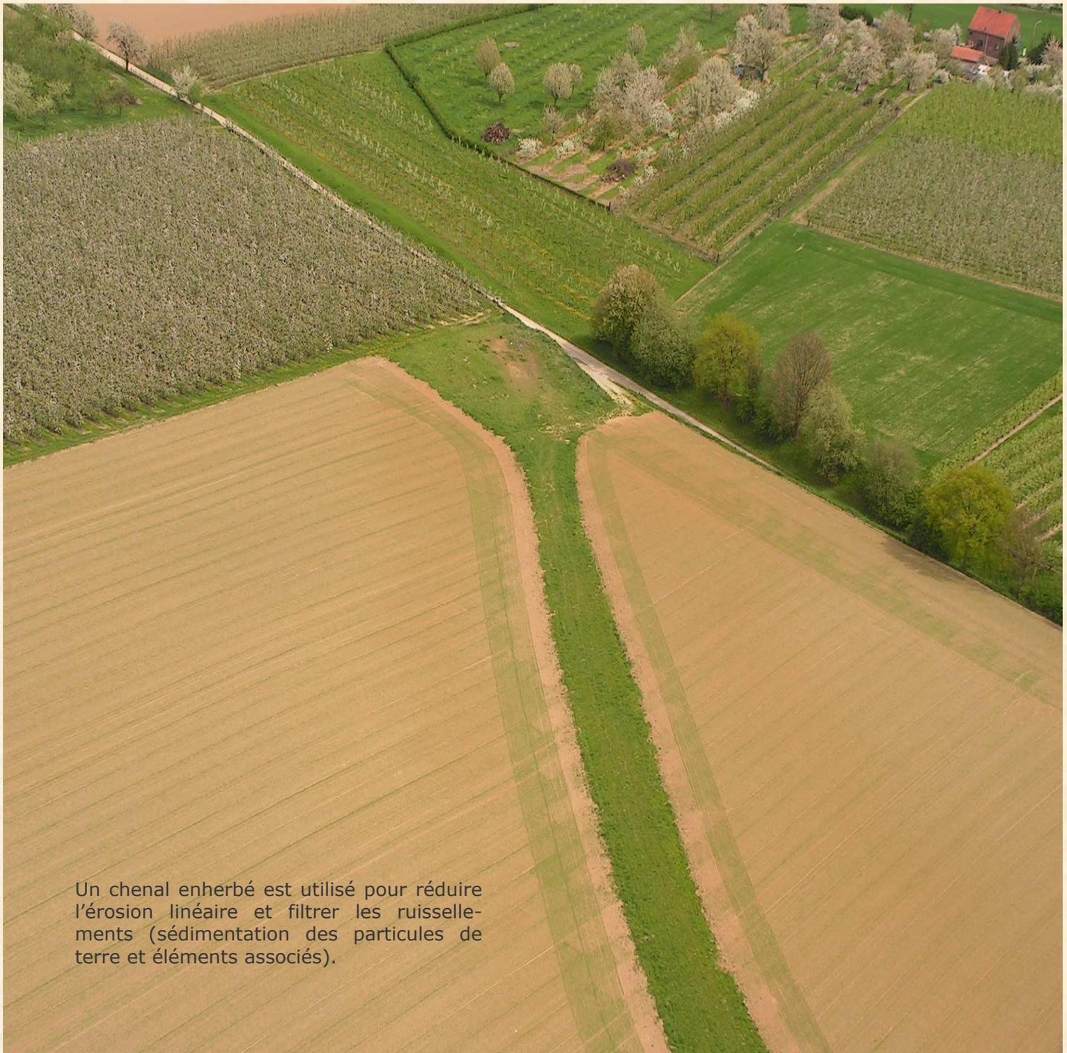
Un chenal enherbé est utilisé pour réduire l'érosion linéaire et filtrer les ruissellements (sédimentation des particules de terre et éléments associés).
